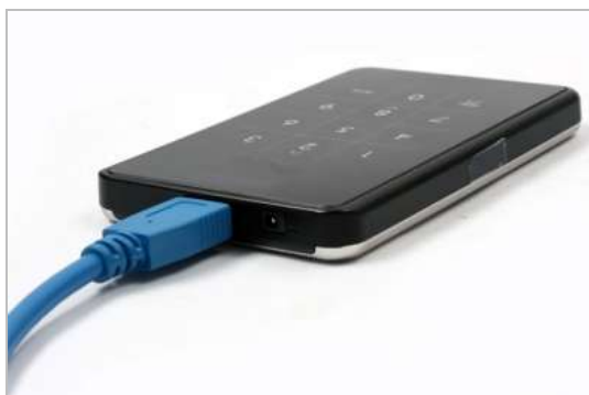
Рис. 3а – подключение контейнера с использованием кабеля USB 3.0 (порт USB 3.0).
