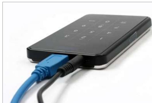
Рис. 3б подключение контейнера с использованием кабеля USB 3.0 и дополнительного адаптера питания (порт USB 2.0).
